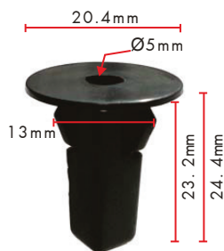
Grapa para vehículos Se adapta a un agujero de 8mm Art. No. 0500920229
