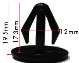
Grapa canoa negro Se adapta a un agujero de 8mm Modelo: MAZDA 8133-50-022 Art. No. 05009200031
