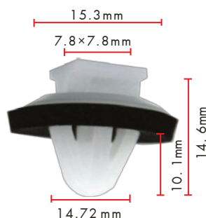
Grapa de anclaje Modelo: TOYOTA 62955-20020, 62955-12010, 90467-10077 / GM 94848834 Art. No. 0500920098
